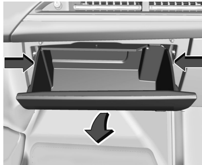
٢. اضغط على جوانب سلة صندوق القفازات للداخل لمسح السدادات وقم بالتدوير لأسفل لخفض السلة.
