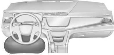
توجد الوسادة الهوائية للركبة الخاصة بالسائق أسفل عمود التوجيه.
