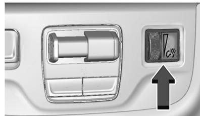
تعمل هذه الميزة على ضبط سطوع جميع عناصر التحكم المضاءة.
