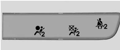
عند بدء تشغيل المركبة، يضيء مؤشر حالة الوسادة الهوائية للراكب الرموز التي تشير إلى التشغيل وإيقاف التشغيل، وذلك لعدة ثوانٍ كعملية فحص للنظام. ثم بعد عدة
