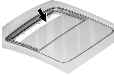
قد تتجمع الأتربة والنفائيات على سداة فتحة السقف أو في مسارها. ويمكن أن يسبب ذلك مشكلة عند تشغيل فتحة السقف أو قد يسبب ضجيجًا. كما يمكن أيضًا أن يسد نظام تصريف المياه. افتح فتحة السقف بشكل دوري وقم بإزالة أي عوائق أو نفائيات متباعدة. امسح سداة فتحة السقف ومنطقة سد السقف باستخدام قطعة قماش نظيفة أو إسفنجية طرية مع الماء. لا تقم بإزالة الشحم عن فتحة السقف.
