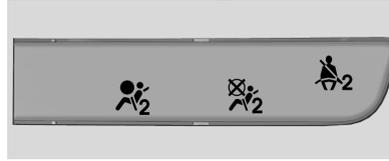
وسيكون رمزا التشغيل وإيقاف التشغيل مرتبين أثناء فحص النظام. عند انتهاء فحص النظام فسوف يظهر إما رمز التشغيل أو رمز إيقاف التشغيل. راجع مؤشر حالة الوسادة الهوائية للراكب ١١٢.
