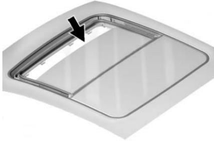
قد تتجمع الأتربة والنفايات على سداثة فتحة السقف أو في مسارها. ويمكن أن يسبب ذلك مشكلة عند تشغيل فتحة السقف أو قد يسبب ضجيجًا. كما يمكن أيضًا أن يسد نظام تصريف المياه. افتح فتحة السقف بشكل دوري وقم بإزالة أي عوائق أو نفايات متباعدة. امسح سداثة فتحة السقف ومنطقة سد السقف باستخدام قطعة قماش نظيفة أو إسفنجية طرية مع الماء. لا تقم بإزالة الشحم عن فتحة السقف.
