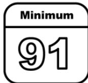
لا تستخدم سوى الوقود الخالي من الرصاص والمصنف بقيمة 91 RON أو أعلى في سيارتك. تجنب استخدام الوقود بنسبة أوكتين أقل لأن ذلك سيؤدي إلى انخفاض الأداء وقدرة الاقتصاد في استهلاك الوقود. راجع الوقود الموصى به (محرك تربييني LT4 V8 سعة ٢,٠ لتر) أو الوقود الموصى به (محرك LGX V6 سعة ٣,٦ لتر) أو الوقود الموصى به (محرك تربييني مزدوج LF3 V6 سعة ٣,٦ لتر و LT4 V8 سعة ٦,٢ لتر) أو ٢٢٧.
